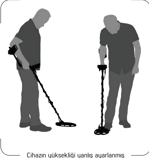
Cihazın yüksekliği yanlış ayarlanmış
