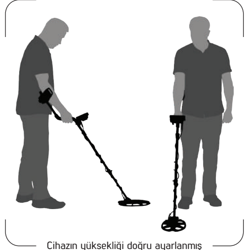
Cihazın yüksekliği doğru ayarlanmış
